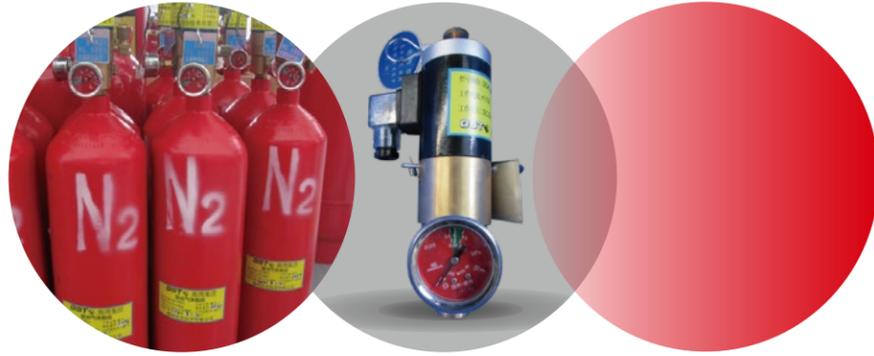
七氟丙烷灭火设备、IG541气体灭火设备均需配置驱动气体瓶组，瓶内灌装有高压氮气，火灾发生时，控制器发出电信号，打开相应的驱动气体瓶组，释放驱动气体，通过气控管路引导开启指定的灭火剂瓶组。
